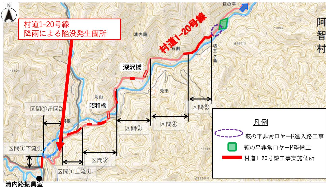
萩の平非常口ヤード整備工事は法面工、補強盛土工、萩の平非常口ヤード進入路工事は〇に示す箇所壁面工を行う予定です。
