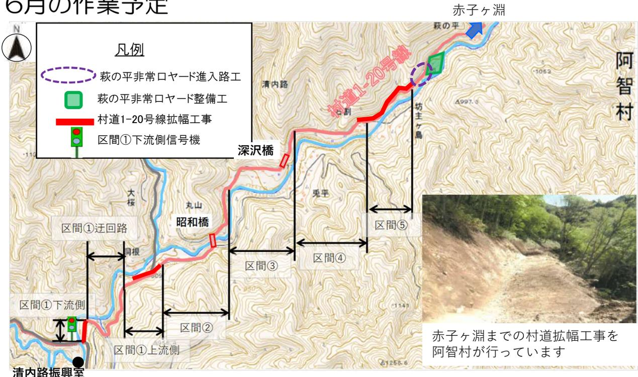
萩の平非常口ヤード造成工事は造成工事、萩の平非常口ヤード進入路工は○に示す箇所で引き続き、切土・法面工を行います。村道1-20号線拡幅工事は、**■**で示す区間①下流側で土工事、法面工、区間①上流側で擁壁撤去・伐採工・家屋解体・土工事、区間④⑤でパンウォール工、区間①～⑤で道路清掃をする予定です。
