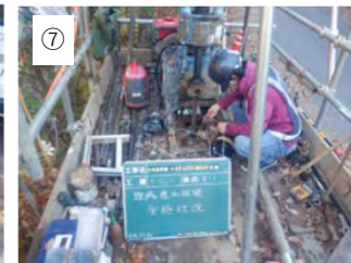
⑦ 【現場透水試験】 この試験は透水係数という地 下の水の流れ易さを調べます。
