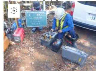
⑥ 【坑内水平載荷試験】 この試験は変形係数という地盤 の固さを調べます。
